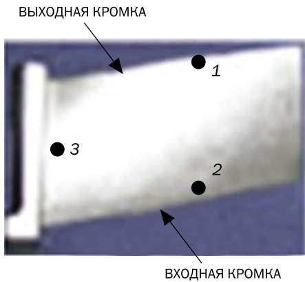
Рис. 2. Схема измерения составляющих напряжений на лопатке компрессора
