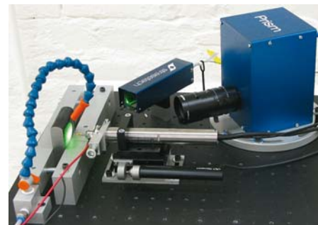
Рис. 1. Типовая установка системы Prism для измерения остаточных напряжений
